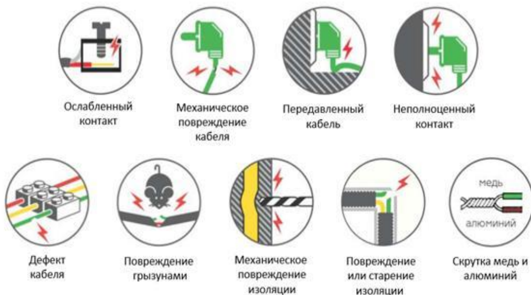
Рисунок 6. Возможные причины искрения в электропроводке
